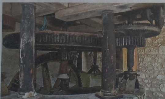
Au sein des engrenages, des dents métalliques s'imbriquent dans des dents en bois dur.
